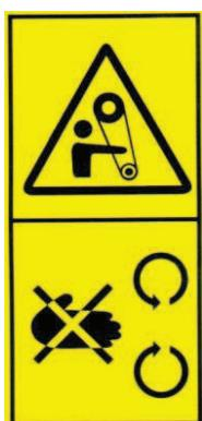
*Obr. 3: Nesahej do prostoru klínového řemene*
